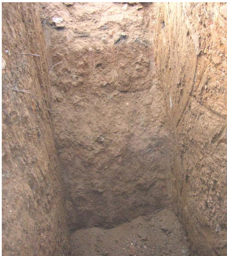
Fig. 13 – Trincea geognostica eseguita presso la S.S. 589.
